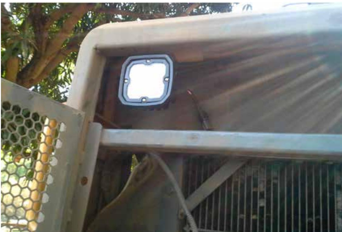
Farol instalado: High Output LED Worklight – Marca Ledpress, conector Deutsch a prova d'água, carcaça em alumínio injetado, lente em policarbonato, 20W de potência, corrente 0,83 A, potência luminosa: 2000 Lumens.
